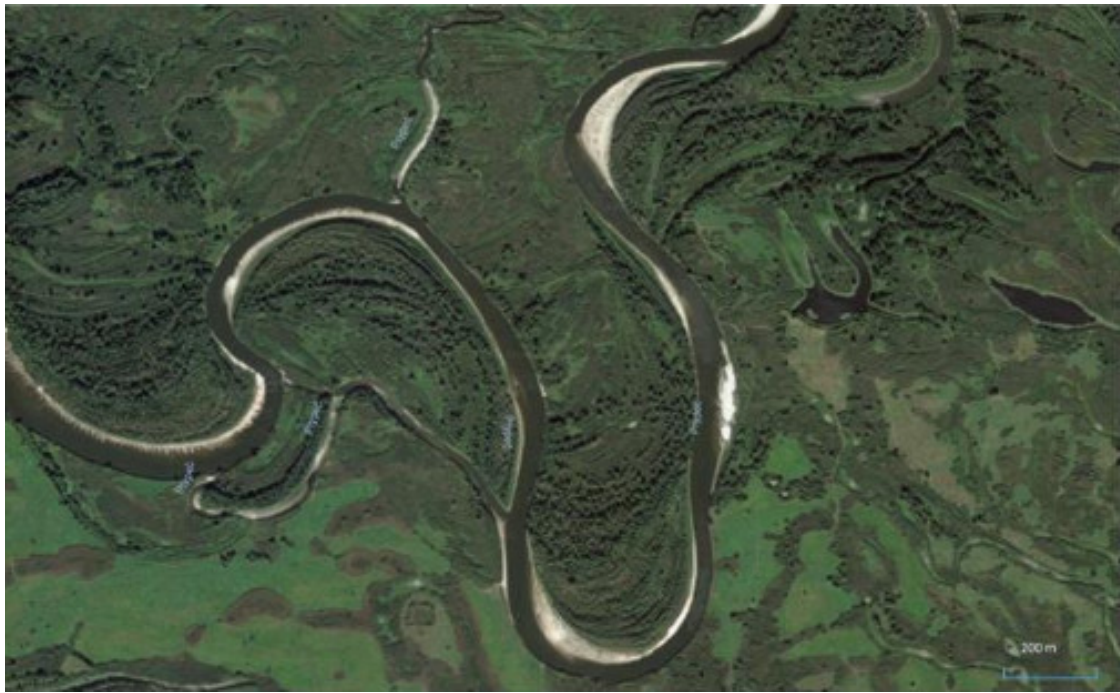
Рис. 2.2 Извилины Припяти в Национальном парке «Припятский». Радиус извилин меньше 200 м, что может создавать значительный риск при навигации судов длиной более 50 м. Ортофотоснимок: Google
